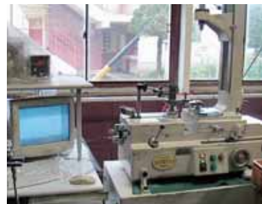
カメラ検査 Mesh Inspection
