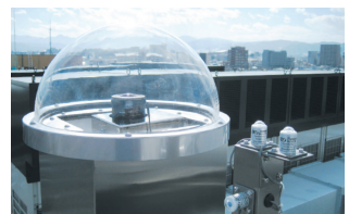
オープンスカイアナライザー「ソラミ」(画像解析センサー)
