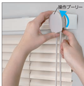
① 操作プーリーの裏のレバーを手前に引きながら、操作プーリーを矢印方向へ45度回転させ、操作プーリーを取外します。
