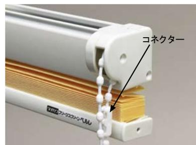
**4** 生地を製品高さの規定の位置に降ろした時にコネクターが写真の位置に来るように、操作部のカバーを外してコネクターを取付けなおしてください。コネクターが操作部にあって生地而降下が止まるような構造になっています。
