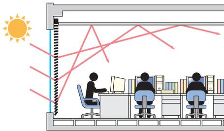
上部のスラットは、自然光をゆるい角度で部屋奥へ、下部のスラットは急角度で天井に反射します。天井からの拡散光で部屋全体が明るく、また窓面に「まぶしさ」を感じない快適な空間となります。
