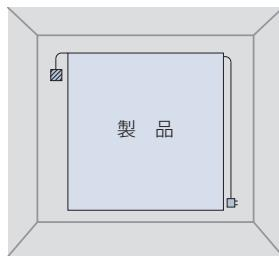
電源コードは室内側から見て、必ず製品の右側から出ます。
