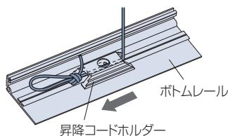
⑤ボトムレールの底面から、高さ調整ネジを昇降コードホルダーへ「カチッ」と音が鳴るまではめ込みます。
