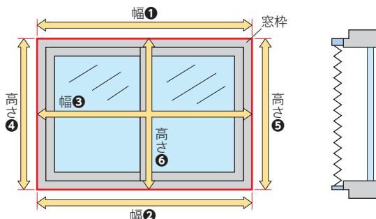
・幅・高さとも窓枠（幅①～③、高さ④～⑥）の外側を測定し、最も大きい寸法以上を製品サイズとしてご指定ください。<sup>※2</sup>
