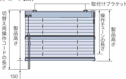
$$\text{切替え用操作コードの長さ} = \text{製品高さ} + 150$$
