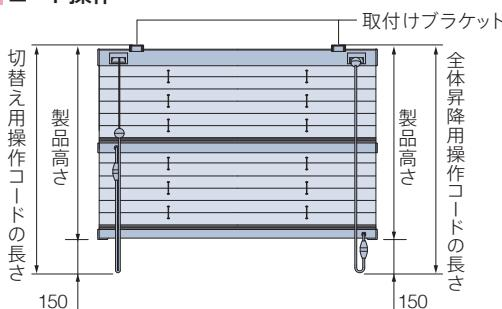
$$\text{全体昇降用操作コード・切替え用操作コードの長さ} = \text{製品高さ} + 150$$
