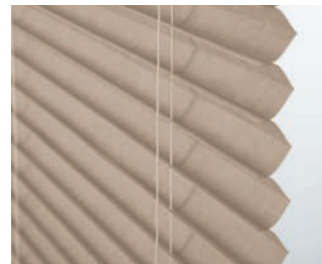
ブリーツの谷部分の裏側をつまんで溶着した部分に昇降コードが通ります。コード穴からの光漏れがありません。
