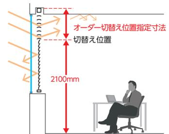
直射光を遮ることで、まぶしさやパソコン画面への映り込みを防ぎます。かつ、スラットの反射を利用した天井からの拡散光で室内全体を明るくします。
