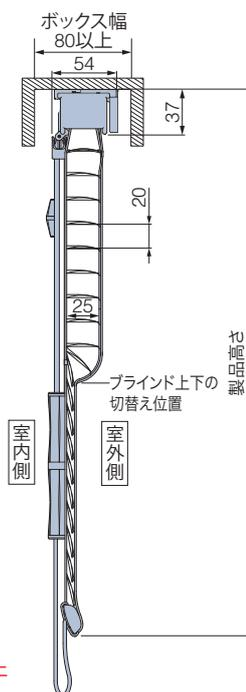
※上部採光の切替え操作時に、製品の構造上ボトムレールが20mm程度上昇します。
