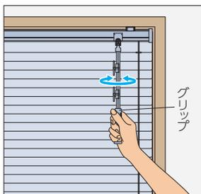
チルトボールのグリップを回転させて、スラットの角度を調整します。
