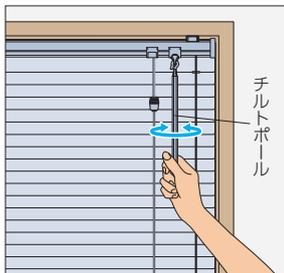
チルトボールを回転させて、スラットの角度を調整します。
