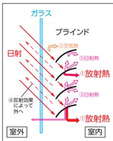
太陽の熱は以下のように、室外から窓ガラスとブラインドを通過し、室内に入ってきます。図のようにガラスの透過した太陽の熱は4つに分かれ、そのうち空気熱・日射熱(短波長)・放射熱(長波長)が室内へ侵入します。
