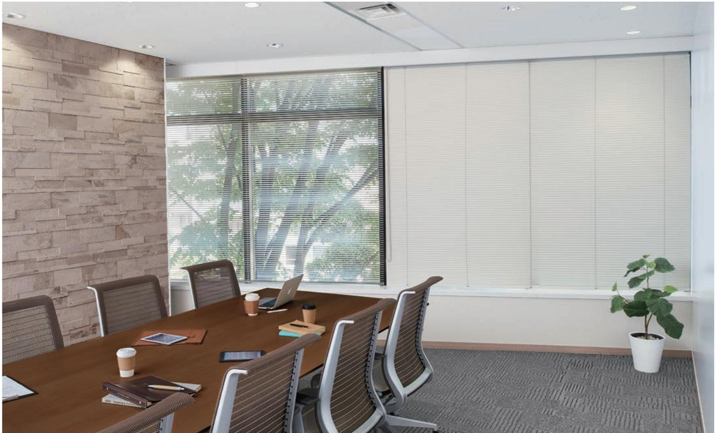
スラット表面のグロス(ツヤ・光沢)をなくした「グロスレス遮熱」スラットで、日中の眩しさを感じる強い反射・ぎらつきを抑制。
