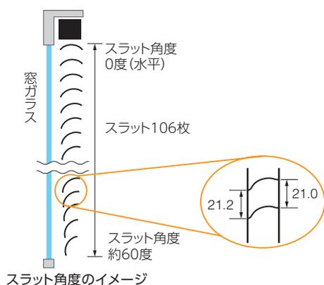
ラダーコードの室外側と室内側の「ピッチ間隔」を変えているため、スラット角度が一枚ごとに変化しています。
