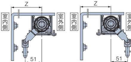
Z寸法：壁面から製品本体(中心)までの寸法
