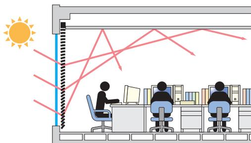
ブラインド上部のスラットは、自然光をゆるい角度で部屋奥へ、下部のスラットは急角度で天井に反射します。天井からの拡散光で部屋全体が明るく、また窓面にまぶしさを感じない快適な空間となります。
