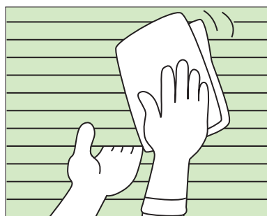
⑤スラット幅が狭い場合は裏面に手をあて洗剤溶液を含ませた雑布でスラットの方向に沿って拭いていきます。
