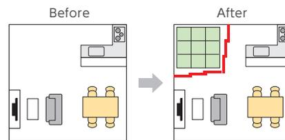
パネルを1枚ずつ移動して重ねて納めます。取手のついたパネルはドアとして出入りができます。
