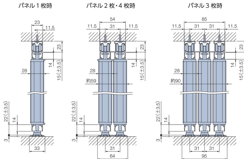
製品詳細図 (下レール:ノンレール)
