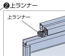
上下方向に3.5mm以内の高さ調整ができます。
