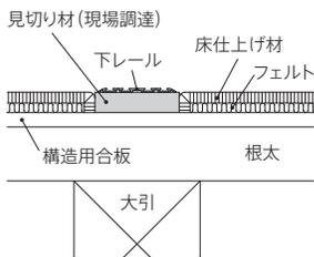
※フラットガイドレールは通常、床面に両面テープ貼りですが、ビスで取付ける場合は、ご注文時にご指定いただくことで、穴加工された下レールにビス(サラタッピングビス φ3.5mm×12mm)が付属されます。
