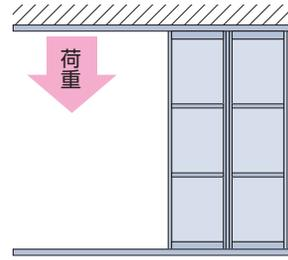
天井面の上レールにパネルを吊るす構造のため、走行がスムーズです。
