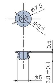
※下レールに穴開けて組み込み、「丸落し」を固定する部品。
