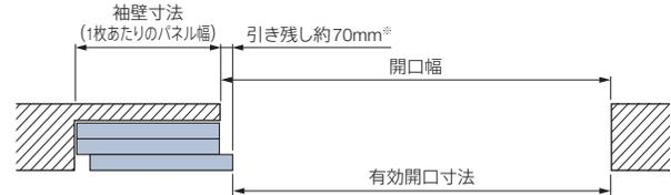
\* 上記はノンレールの場合です。フラットガイドレールの場合、引き残しはなく、有効開口寸法は開口幅と同じになります。
