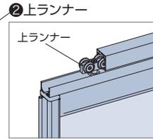
上下方向に3.5mm以内の高さ調整ができます。
