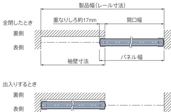
① 開口幅をもとに「製品幅」と「パネル幅」を算出します。
