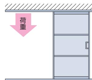
天井面の上レールにパネルを吊るす構造のため、走行がスムーズです。
