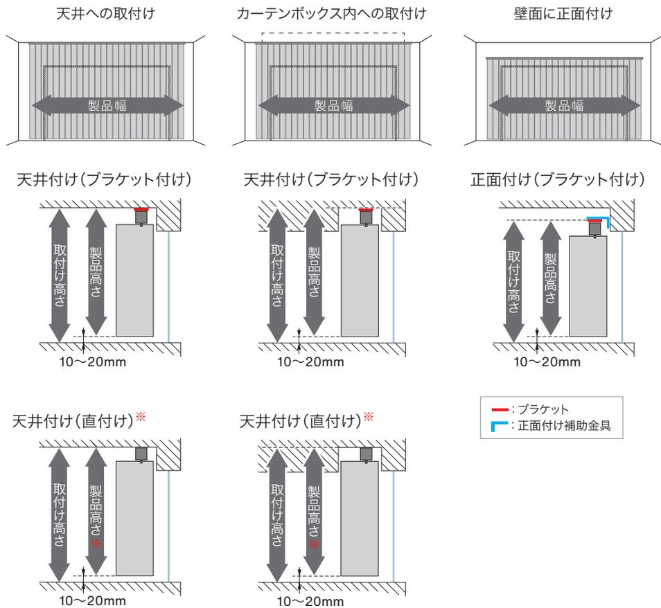
※天井付け(直付け)の場合、製品高さはブラケット厚の4mm分短くなります。
