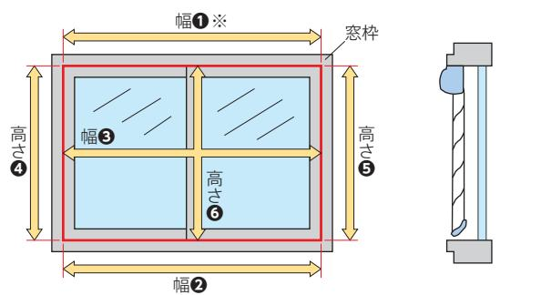
・幅は窓枠の上部（幅①）、下部（幅②）、中央部（幅③）の3カ所の内側を測定し、最も小さい寸法から10mm以上<sup>※1</sup>引いてください。
