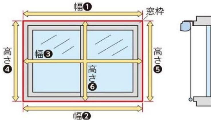
幅・高さとも窓枠（幅①～③、高さ④～⑥）の外側を測定し、最も大きい寸法以上を製品サイズとしてご指定ください。
