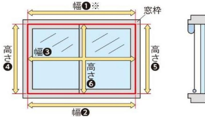
・幅は窓枠の上部（幅①）、下部（幅②）、中央部（幅③）の3ヶ所の内側を測定し、最も小さい寸法から10mm以上引いてください。
