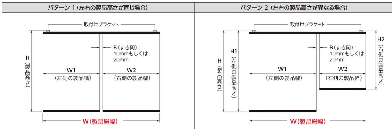
$$W \text{ (製品総幅)} = W1 \text{ (左側の製品幅)} + B \text{ (すき間寸法: 10mmもしくは20mmを指定)} + W2 \text{ (右側の製品幅)}$$
