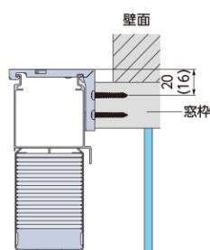
取付けブラケットのビス穴位置を、各製品仕様の「ブラケット図」で確認し、窓枠の厚みや仕上がり高さ・取付け位置を考慮して製品高さを決めてください。
