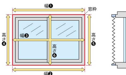
・幅・高さとも窓枠（幅①～③、高さ④～⑥）の外側を測定し、最も大きい寸法以上を製品サイズとしてご指定ください。<sup>※2</sup>
