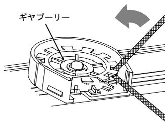
※自動停止機能が働いてギヤプリーが回転しなくなる場合があります。その場合は逆方向の回転でコードを取付けてください。自動停止機能も解除されます。
